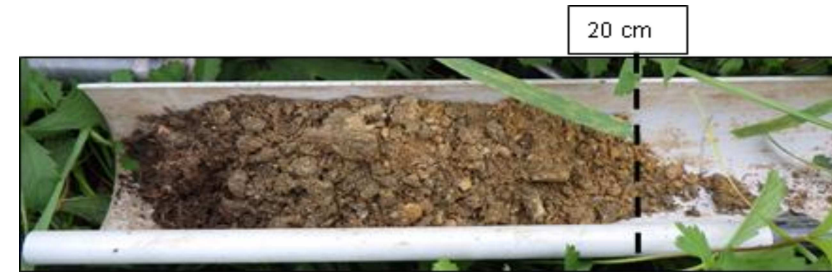
Figure 28 : Sondage n°2 – Présence de remblais après 20 cm de profondeur (zone non humide) (Source : IEL)
