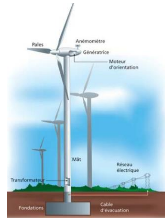
Figure 15 : Représentation schématique d'une éolienne (Source : EDF)
