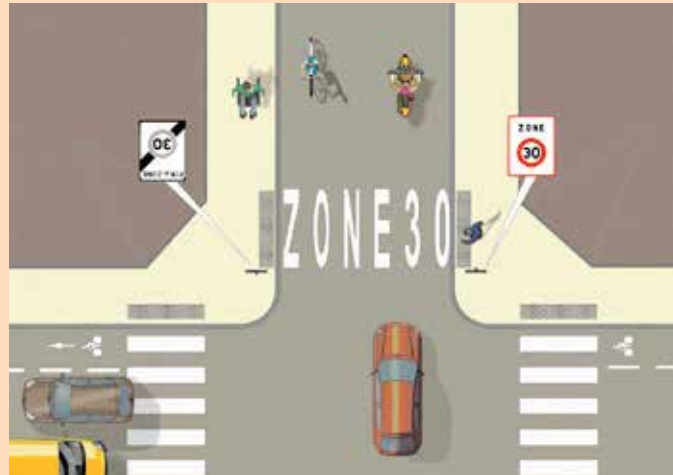
Entrée de zone 30 : positionnement des bandes d'éveil et de vigilance
